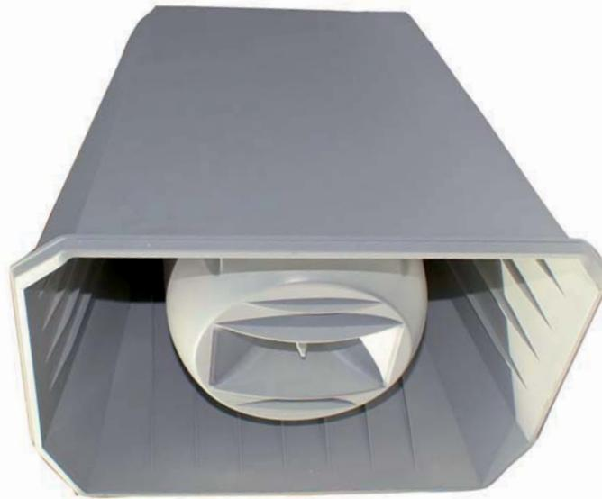
**Breitband-Hornlautsprecher in verschiedenen Leistungsstärken, mit guter Rückschalldämpfung. Wetterfestes Gehäuse aus ABS-Kunststoff mit Aluminium-Befestigungsbügel. Eingebauter 100-V-Anpassungsübertrager.**
